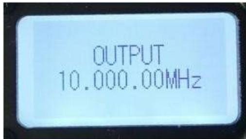
この時、周波数カウンターを使ってPCBボード上のTESTポイント（電源ソケット付近）の周波数を検出し、大型ノブを回して周波数カウンターの表示が10.000.00MHzになるように調整し、M/V/SAV ボタンを押して終了します。
