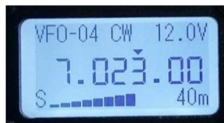
このボタンを押すと、記憶周波数（MEM）と VFO が切り替わります。LCD の左上には MEM-\*\*または VFO-\*\*が表示されます（\*\*は 01～08 の数字）。MEM-\*\*が表示されているときは、周波数モードで記憶されています。この時、大型メインダイヤルノブを回すことでメモリーチャンネルを変更することができ、時計回りに回すと増加、反時計回りに回すと減少します。VFO-\*\*と表示されると、周波数モードに変更されます。この時、メインダイヤルノブを回
