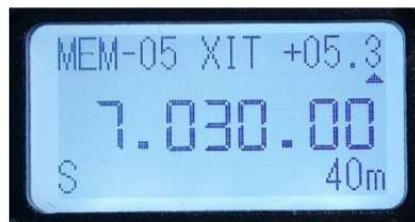
このボタンをタップすると、受信微調整と送信微調整（RITとXIT）の機能に入ったり、終了したりします。このとき、液晶画面の右上には、RITまたはXITとその微調整の内容が表示されます。微調整状態に入ってからチューニング大つまみを押すと、微調整用 RIT の受信と微調整用 XIT の送信が切り替わります。
