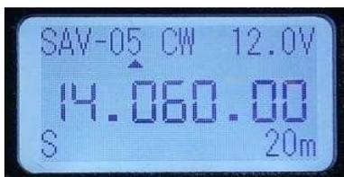
MM/SAV ボタンを 2 秒以上押すと、現在の周波数と動作モードが現在のメモリー位置に保存されます。液晶画面の左上に SAV-\*\*の文字が表示されます。電源を入れるたびに、前回保存したときの周波数と動作モードになります
