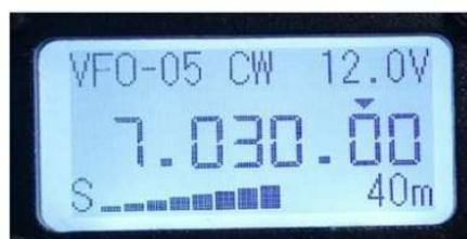
メインダイヤルをタップすると、10Hz、100Hz、1KHz、100KHz と切り替わります。ステップ周波数が変更されると、液晶画面の対応する周波数表示位置の上に小さな三角マークが表示されます。MEM 状態の時にメインダイヤルを押すと、VFO 動作状態になります。
